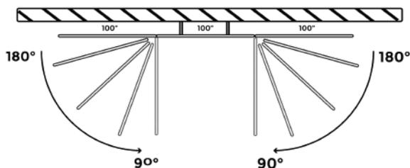
L'apertura delle ali laterali si può regolare liberamente in fase di installazione con un angolo che varia dai 180° a 90°.
